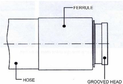
Les raccords sont réalisés en acier carbone trempé. Le système de raccordement full flow/passage intégral facilite l'écoulement du béton lors de l'utilisation.
